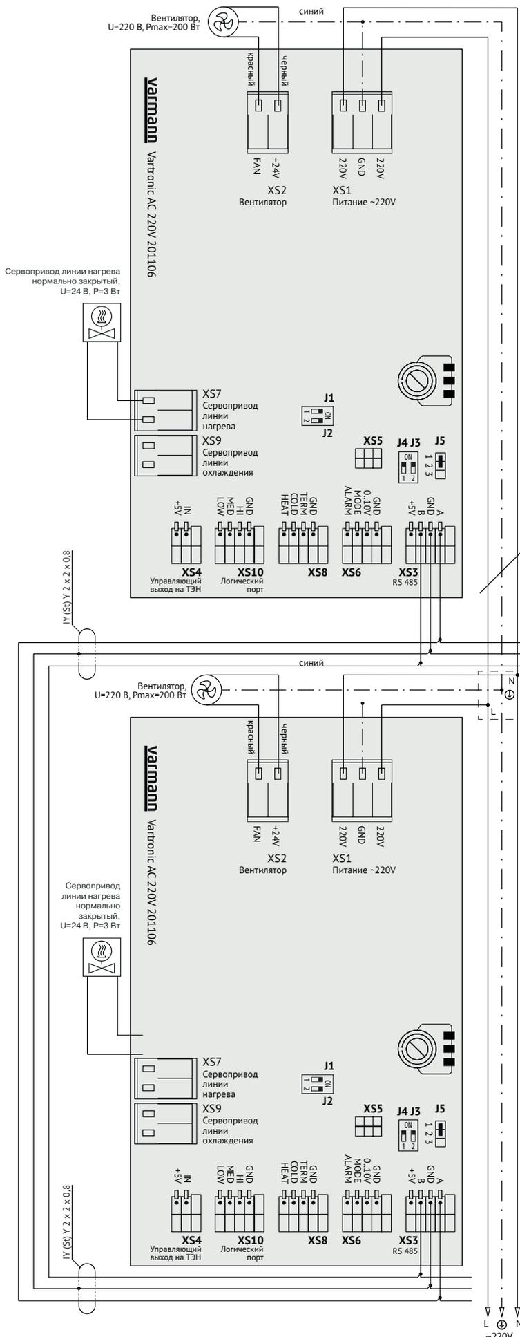
Настенный регулятор Vartronic 703201/703202 осуществляет регулирование температуры воздуха в помещении посредством плавного изменения скорости вращения вентиляторов и управления термоэлектрическим сервоприводом для изменения расхода теплоносителя, проходящего через теплообменник тепловентилятора.
