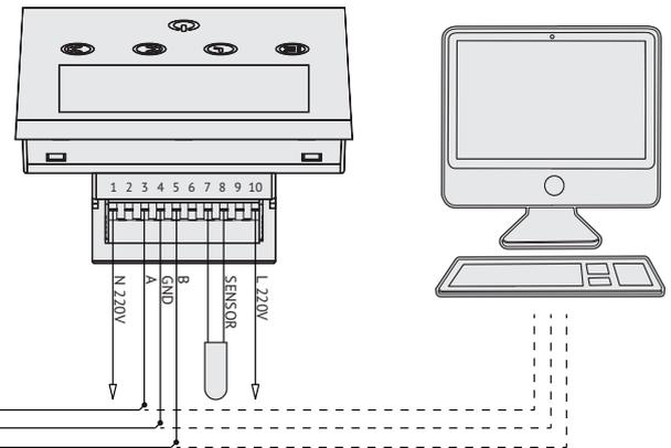
В блоках регулирования Vartronic 201106 используется совместимый последовательный интерфейс RS-485. Блоки регулирования соединяются, используя технологию «главный-подчиненный», при которой только одно устройство (настенный регулятор или HOST-PC) может инициировать передачу данных и делать запрос.
