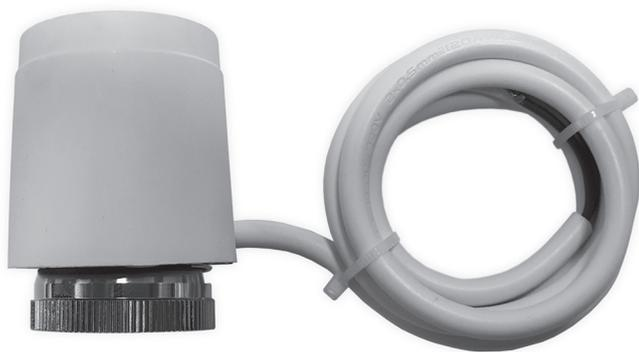
Термоэлектрический сервопривод с напряжением питания ~220 В (тип 702361) или -24 В (тип 702371) предназначен для монтажа на термостатический вентиль подающей линии конвекторов Varmann с резьбовым соединением М 30 х 1,5.
