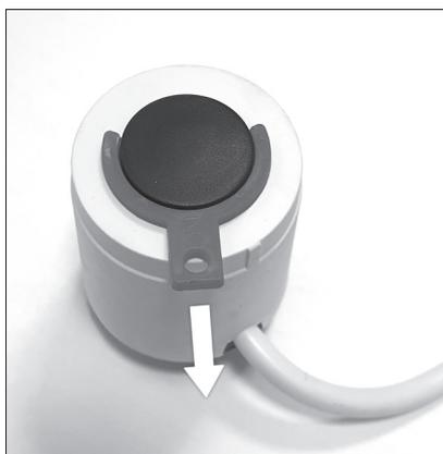
Термоэлектрический сервопривод имеет нормально закрытое положение. Ход штока сервопривода составляет 5 мм. В верхней части корпуса расположена защитная клипса для блокировки хода штока и удобства монтажа сервопривода на термостатический вентиль конвектора. После установки сервопривода красную защитную клипсу необходимо удалить с его корпуса.
