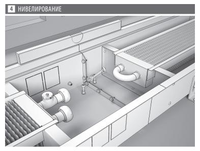
Используя уровнемер, установите корпус конвектора в горизонтальное положение. Декоративная рамка двух конвекторов должна соединяться без перекоса и зазоров. При необходимости, разберите болтовое фланцевое соединение и отшлифуйте торец декоративной рамки (см. п.2)
