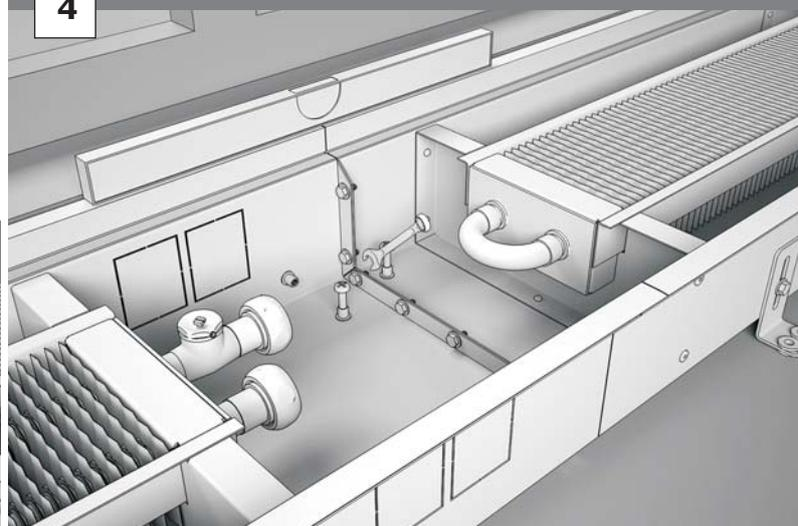
Используя уровень, установите корпус конвектора в горизонтальное положение.
