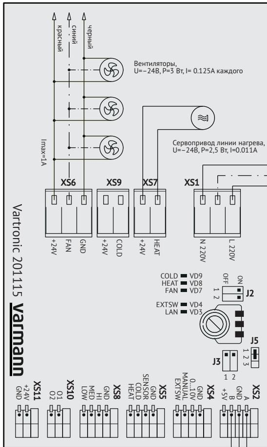
Настенный регулятор Vartronic 703201, 703202 осуществляет регулирование температуры в помещении посредством плавного изменения скорости вращения вентиляторов и управлением термоэлектрическим сервоприводом для изменения расхода теплоносителя через теплообменник конвектора.
