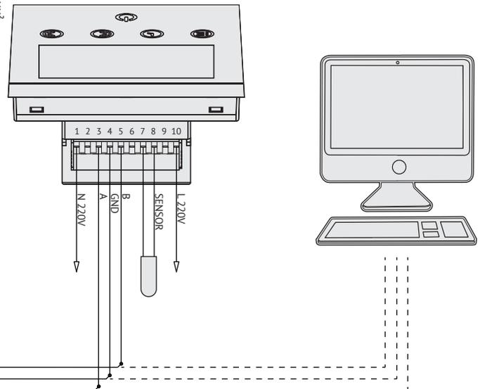
В контроллерах Vartronic используется RS-485 совместимый последовательный интерфейс. Контроллеры соединяются используя технологию главный-подчиненный, при которой только одно устройство (настенный регулятор или HOST - PC) может инициировать передачу и делать запрос.
